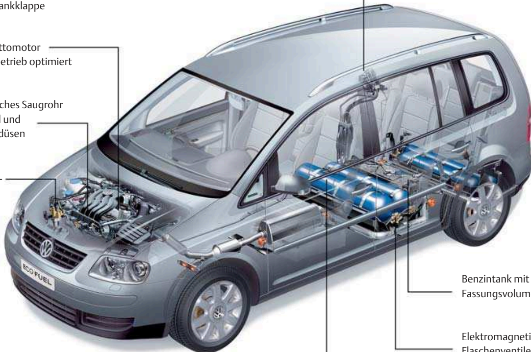
Einbaubeispiel Touran 2.0 EcoFuel, werkseitig (Foto: Volkswagen AG)
